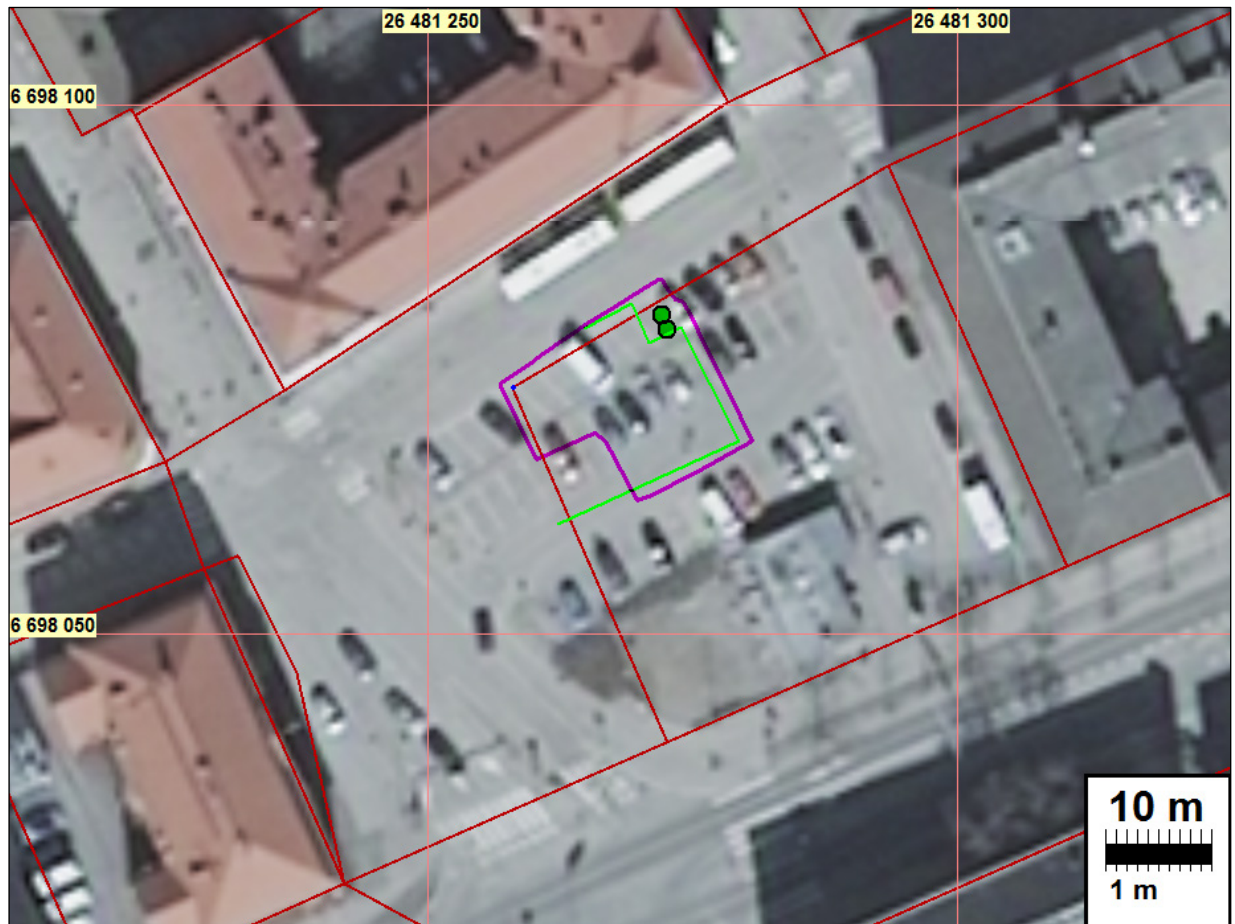
Kaivettu alue sinipunaisella. Huoltoaseman betoniperustan ulkoraja vihreällä.
